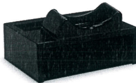
Chambre noire avec fenêtre de protection UV
